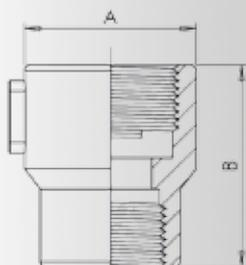
**Codificação:** N = NPT, B = BSP, F = Ferro galvanizado eletrolítico, FG = Ferro galvanizado a fogo, A = Alumínio.
